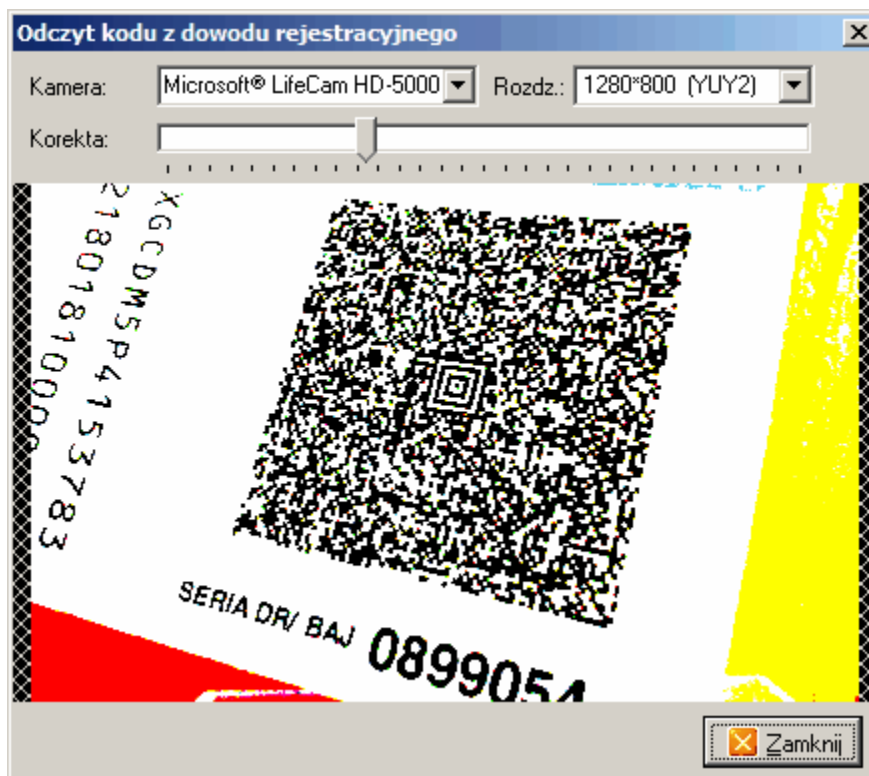
Rys. 9 kamera nie ustawiona prostopadle i zbyt blisko kodu - optymalna odległość to ok 7-9 cm
